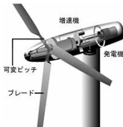
資-図 1.2-3 風力発電機の構造
